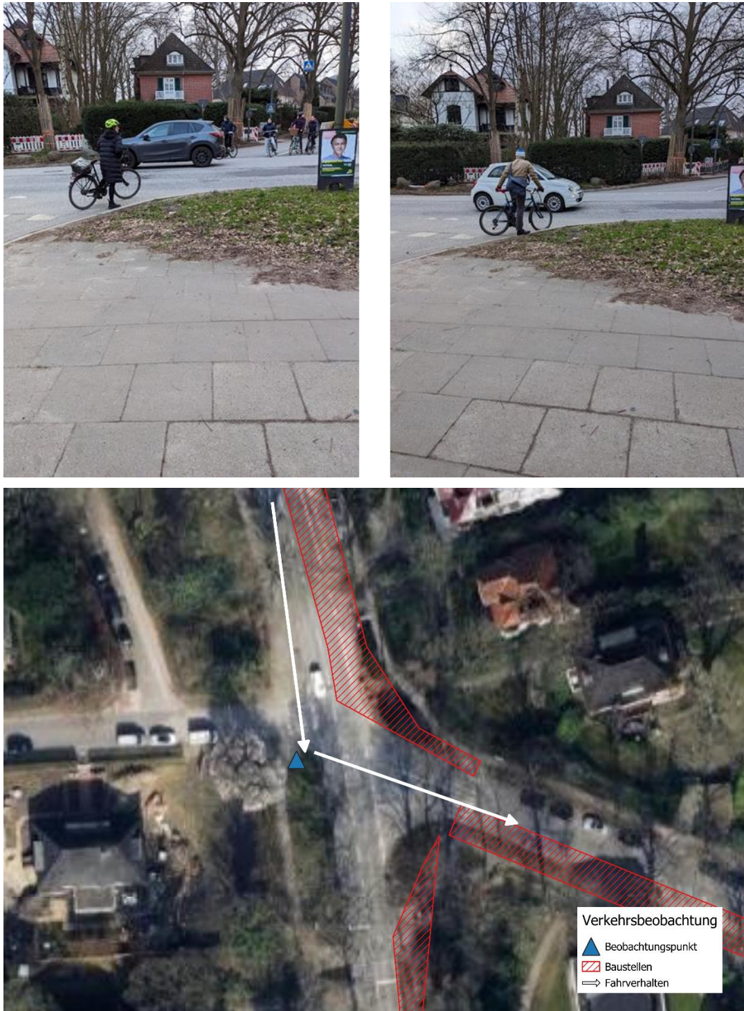
Abbildung 14: Variante 2: Indirektes Abbiegen von Radfahrenden
